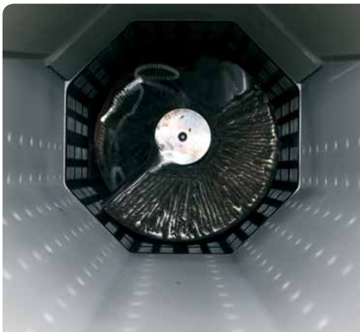
Pansrad skruvspets för ökad livslängd
