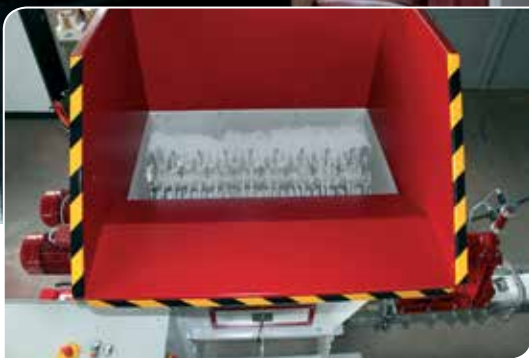
En effektiv grovkvarn med tvåtandade roterande axlar
